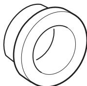
диск накладывается на втулку (C) между внутренней фланцевой шайбой (A) и фланцевой шайбой (B). Фланцевая шайба поворачивается вокруг так, чтобы она подошла на ось.
