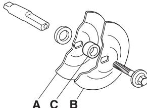
Винт, которым закреплен режущий диск должен быть затянут с усилием в 15-25 Нм.
